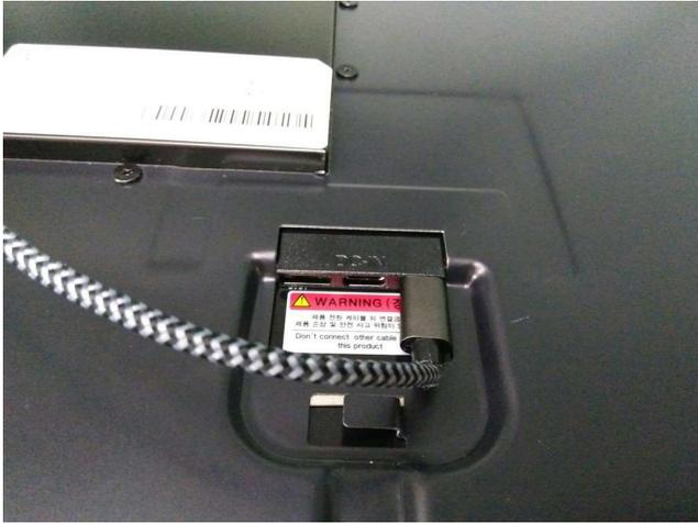
Verbinden Sie den USB HUB über den Micro USB Port mit dem Display
