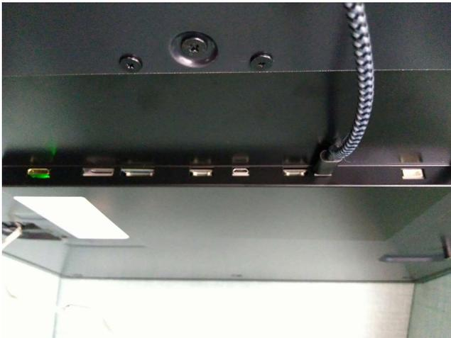
Wenn Sie die HDMI Variante des Displays verwenden, verbinden Sie den USB HUB mit diesem Micro USB Port
