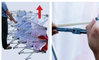
Stellen Sie nun das Display senkrecht und klinken Sie die Haken von der Mitte beginnend ein. Gehen Sie in alle Richtungen gleichmäßig vor, da das System zunehmend unter Spannung steht! Es müssen alle Hakenverbindungen geschlossen werden, um ein optimales Aussehen des Displays zu erreichen.
