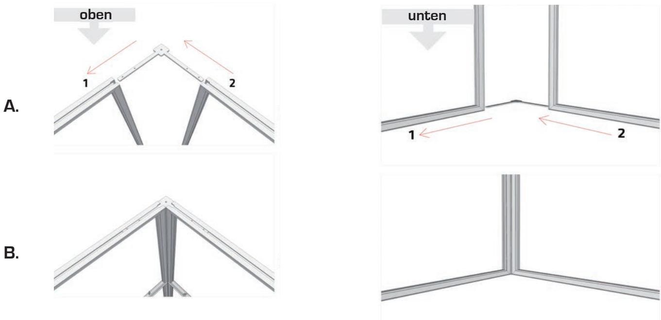
Dann durch die Öffnung im Rahmen Flügelschrauben in die Verbindung einschrauben
