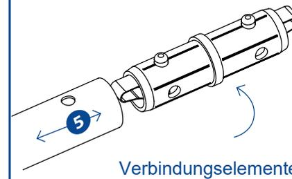
Drücken Sie die Einrastknöpfe herunter und verbinden Sie die vertikalen mit den horizontalen Verbindungsstangen.
