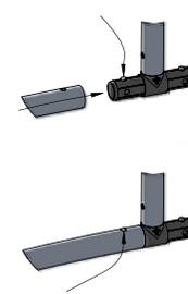
Drücken Sie die Einrastknöpfe herunter und verbinden Sie die vertikalen mit den horizontalen Verbindungsstangen.
