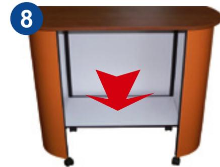
Danach in dem unteren Teil der Konstruktion den Boden einsetzen.
