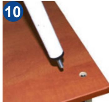
In der Thekenplatte befinden sich Öffnungen für die Stangen des Topschildes.
